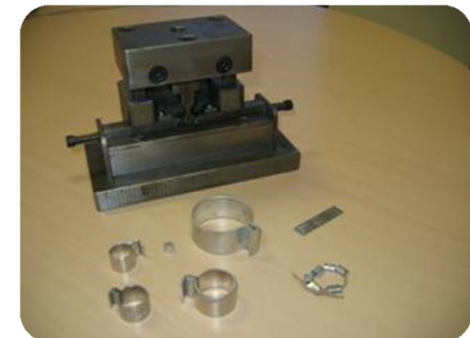
▲ Antigua troqueladora, con la que se hacían las anillas a mano, una a una.
